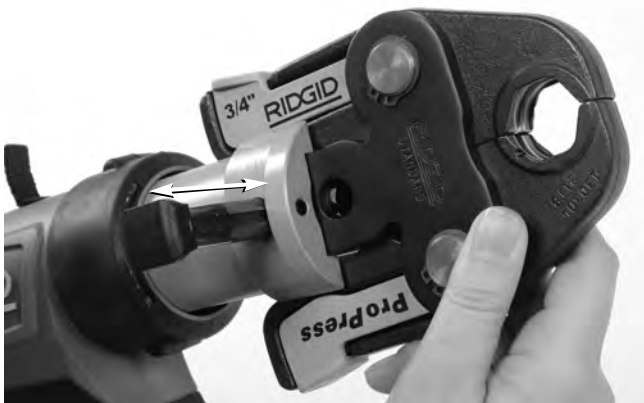
Figura 7 – Pasador de montaje de accesorios
