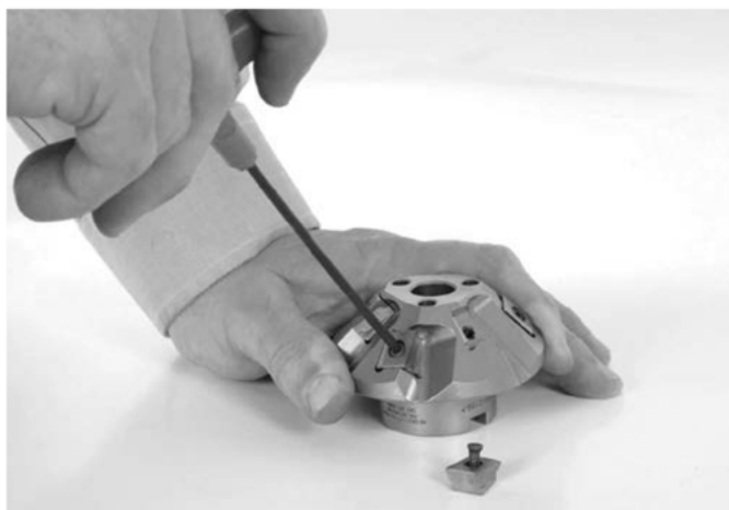
Obrázek 18 – Výměna řezacích vložek
