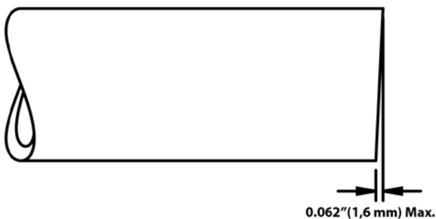
Obrázek 6 – Požadavky rovnosti trubky
