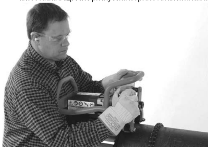
Obrázek 10A – Ručně dotáhněte upínací šroub
