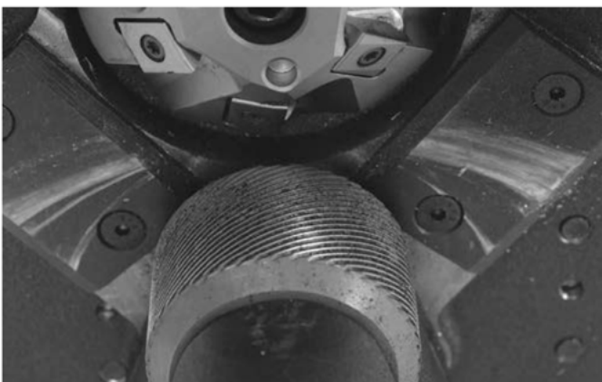
Obrázek 16 – Vyčistěte rýhování hnacího válce
